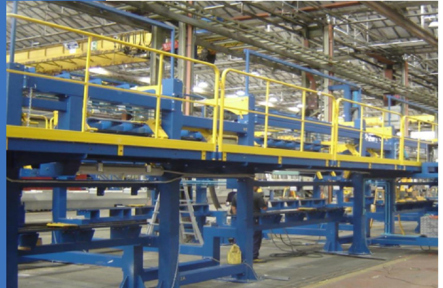
**Scalo di montaggio per carrozze ferroviarie**
